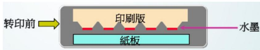
图 5-3 印刷工序示意图
